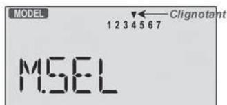
3. Sélectionnez le numéro du modèle désiré en pressant les boutons "**à droite**" ou "**à gauche**". A cet instant, la petite flèche au-dessus du modèle choisi clignotera.
