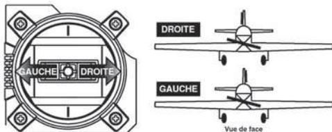
Si le servo de direction se déplace dans la mauvaise direction, déplacez-vous dans le menu **REV** pour atteindre la voie 4 en appuyant sur la touche "à droite". Maintenant le 4 sur l'écran doit clignoter. Activez l'inversion du sens de rotation du servo en appuyant sur la touche **Clear**. Déplacez le manche gauche de nouveau et vérifiez que la dérive se déplace dans la bonne direction.
