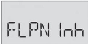
13. Activez la fonction **flaperon** en appuyant sur la touche **Clear** (Active/inhibit) jusqu'à ce que **ON** apparaisse à l'écran.
