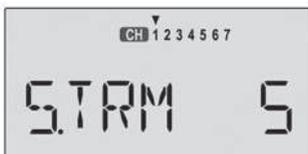
2. Appuyez sur la touche "à droite" ou "à gauche" jusqu'à ce que la petite flèche vienne au-dessus de la voie que vous voulez régler (la figure ci-dessus montre le réglage subtrim de la voie 1 (**CH1**)).
