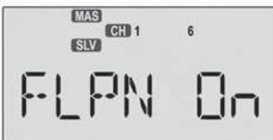
14. Vérifiez que vous avez branché le servo d'**aileron droit** à la **voie 1** du récepteur et le servo d'**aileron gauche** à la **voie 6**.
