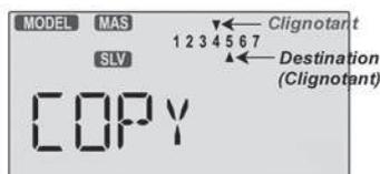
3. La mémoire source ou originale (la copie effectuera une image de celle-ci) est la mémoire courante, pointée par la flèche supérieure. Pour sélectionner alors la destination mémoire, appuyez sur les boutons "à gauche" ou "à droite". La mémoire destination est alors pointée par la flèche clignotant en dessous de son numéro.
