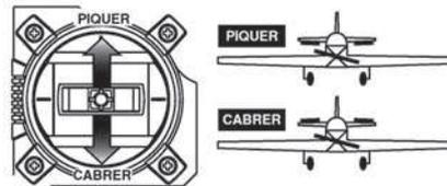
19. Si la gouverne de profondeur se déplace dans le mauvais sens, déplacez-vous dans le menu **REV** pour atteindre la voie 2 en appuyant sur la touche "**à droite**". Maintenant le 2 sur l'écran doit clignoter. Activez l'inversion du sens de rotation du servo en appuyant sur la touche **Clear** (Active/Inhibit). Poussez et tirez alternativement le manche gauche et vérifiez que la gouverne de profondeur se déplace dans la bonne direction.
