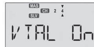
7. Réglez maintenant l'influence de la direction sur l'empennage droit (voie 2) en appuyant une fois sur la touche "**à droite**". La petite flèche inférieure pointe au dessous du chiffre 2 et vous pouvez ajuster le débattement de l'empennage droit en utilisant les touches **Data +** et **Data -**. 50% est une bonne valeur de base. En appuyant sur la touche **Clear**, vous pouvez initialiser cette valeur à 0%.
