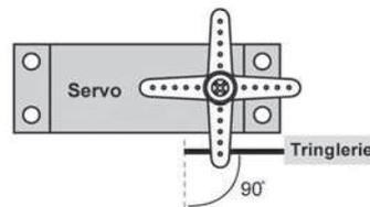
Ajustez les chapes de chaque tringlerie pour que la position des gouvernes soit aussi proches que possible du neutre (c'est à dire alignée dans le prolongement de l'aile, du stabilisateur ou de la dérive).
