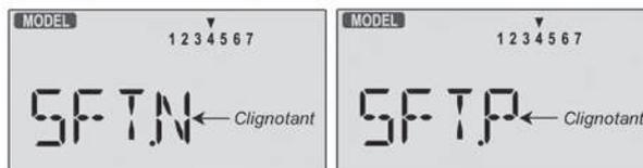
3. **N** représente une modulation négative et fonctionnera avec les récepteurs HITEC et FUTABA. **P** représente une modulation positive et fonctionnera avec et les récepteurs MULTIPLEX, JR et AIRTRONICS.
