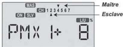
3. Programmez ensuite la voie esclave, celle qui est affectée par le mouvement de la voie maître. Appuyez sur la touche "à droite" pour que l'indicateur **SLV** clignote, puis appuyez sur les touches **Data +** et **Data -** pour déplacer la flèche inférieure sous le numéro de la voie esclave souhaitée.
