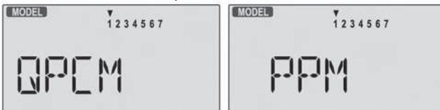
3. **PPM** est le type le plus fréquent appelé FM et qui fonctionne avec tous les récepteurs non PCM. **QPCM** représente une modulation numérique codée et ne fonctionnera qu'avec les récepteurs HITEC QPCM.
