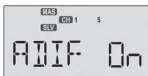
7. Vérifiez que vous avez branché le servo d'**aileron droit** à la **voie 1** du récepteur et le servo d'**aileron gauche** à la **voie 5**.
