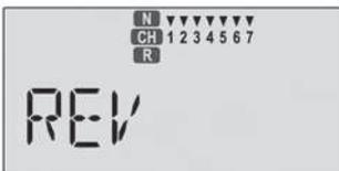
16. Commencez par régler le sens de rotation du servo d'aileron droit. Etant la voie 1, le chiffre 1 doit clignoter sur l'écran. Lorsque vous poussez le manche droit vers la droite, l'aileron droit doit se déplacer vers le haut et l'aileron gauche doit se déplacer vers le bas avec l'avion vue de face. Reportez-vous au schéma ci-dessous et vérifiez uniquement pour l'instant le sens de fonctionnement de l'aileron droit.
