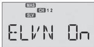
4. Appuyez une fois sur la touche "**à droite**" pour accéder au réglage de la profondeur. Une petite flèche s'affiche au dessus du chiffre 2 qui représente la voie maître (profondeur) avec le sigle % qui clignote. La petite flèche au dessous du 2 indique que l'élevo gauche est en cours de réglage.
