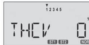
4. Passez maintenant au **point 2** en pressant sur la touche "à droite", la petite flèche se déplace au dessus du **chiffre 2**. Ce point est inactif (**Inh**) par défaut. Si vous ne l'activez pas, vous aurez une ligne droite du point 1 au point 3. Sinon, pour régler le point 2, appuyez sur la touche **Data +** ou **Data -**.
