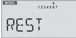
3. SI VOUS ETES SUR DE VOULOIR REINITIALISER et remettre à zéro la mémoire du modèle courant, appuyez simultanément sur les touches **Data +** et **Data -**. L'émetteur "bip" deux fois rapidement, indiquant que l'initialisation s'est effectuée correctement.
