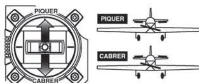
14. Si la gouverne de profondeur se déplace dans le mauvais sens, allez à la voie 2 en appuyant sur la touche "**à droite**". Maintenant le 2 sur l'écran clignote. Inversez le sens de rotation du servo en appuyant sur la touche **Clear**. Actionnez le manche gauche et vérifiez que la gouverne de profondeur se déplace dans la bonne direction.
