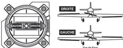
17. Si ce n'est pas le cas, inversez le sens de rotation du servo de la voie 1 en appuyant sur la touche **Clear** (Active/Inhibit). Chaque pression fait basculer le sens de rotation du servo. Sur l'écran, **N** (sens normal) est choisi quand la flèche est au dessus du numéro de la
