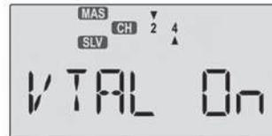
6. Maintenant vous allez régler l'influence de la direction sur l'empennage gauche (voie 4) en appuyant une fois sur la touche "**à droite**". Les petites flèches pointent simultanément au dessus et en dessous du chiffre 4 et vous pouvez ajuster le débattement de l'empennage gauche en utilisant les touches **Data +** et **Data -**. 50% est une bonne valeur de départ. En appuyant sur la touche **Clear**, vous pouvez remettre à 0% cette valeur.
