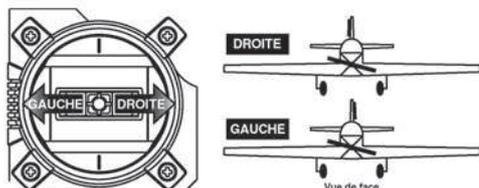
Si le servo de direction se déplace dans la mauvaise direction, allez à la voie 4 en appuyant sur la touche "à droite". Maintenant le 4 doit clignoter sur l'écran. Activez l'inversion du sens de rotation du servo en appuyant sur la touche **Clear**. Déplacez le manche gauche de nouveau et vérifiez que la dérive se déplace dans la bonne direction.
