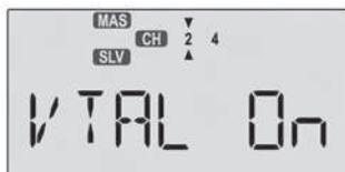
5. Si l'empennage gauche (voie 4) se déplace vers le bas avec la profondeur cabrée, changez son sens de débattement en appuyant sur la touche "**à droite**" (la flèche du bas se déplace sous le chiffre 4). Pressez la touche **Clear** pour initialiser la valeur à 0%, puis appuyez sur la touche **Data -** pour atteindre la valeur de -50%. Sinon passez à l'étape suivante.
