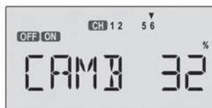
**Note : Soyez prudent lors des premiers vols avec la fonction CAMB activée car les ailerons perdent de leur efficacité. Vérifiez d'abord les effets de ce réglage à haute altitude pour ne pas prendre de risque.**
