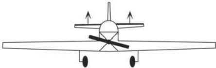
5. Appuyez sur la touche "à droite" pour aller à l'écran de réglage des débattements. Vous verrez une flèche sur le chiffre 1 et une autre sous le chiffre 2 signifiant que vous êtes dans le menu **AIL->CH2**. Vous programmez le réponse du servo de voie 2 (stabilisateur droit) par rapport à la commande du manche d'aileron.
