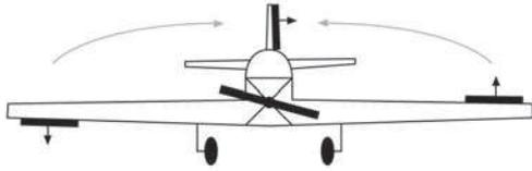
Plus le modèle vol lentement, plus le mixage est nécessaire et inversement. Les vols lents sont plus réalistes avec nos modèles réduits. Le taux de mixage dépend fortement de la configuration du modèle. En général, seul un peu de direction est nécessaire. Il sera aussi utile de mettre un peu de différentiel d'aileron en utilisant le menu **EPA**. Une bonne valeur de départ est de limiter le débattement des ailerons vers le bas entre 50% et 75% de celui vers le haut.
