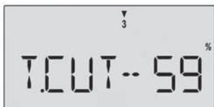
**19. Réglage de la courbe de gaz :** Vous utiliserez le réglage de la courbe des gaz en 5 points (**THCV**) pour ajuster au plus fin le régime moteur en fonction du pas collectif. Réglez le régime moteur en stationnaire pour faire tourner le rotor principal à 1500T/min. Vous pouvez modifier la courbe afin de l'aplatir autour du stationnaire et l'accentuer pour les positions extrêmes. Reportez-vous au chapitre **THCV** de la **page 52** pour plus de détails sur cette fonction.
