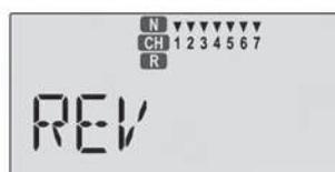
11. Commencez par régler le sens de rotation du servo d'aileron droit. Etant la voie 1, le chiffre 1 doit clignoter sur l'écran. Lorsque vous poussez le manche droit vers la droite, l'aileron droit doit se déplacer vers le
