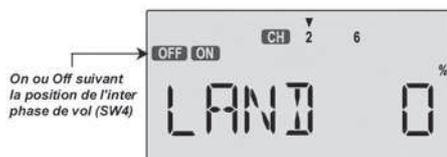
**57.** La flèche doit pointer sur le chiffre 2. Appuyez maintenant sur la touche **Data +** pour changer la valeur (en %) de compensation pour la profondeur. Cette valeur doit être comprise entre -7% et -10%. Au-delà de ces valeurs, vous pourriez perdre le contrôle de votre modèle et le crasher par terre.
