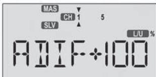
2. Une petite flèche, s'affichant sous le chiffre 1, indique que vous allez régler la voie 1 (aileron droit). Pour définir du différentiel vers le bas sur l'aileron droit (**voie 1**), maintenez le manche des ailerons à gauche (l'indicateur **L/U** apparaît à l'écran) et appuyez sur la touche **Data -** (l'aileron droit se déplace alors vers le bas quand le manche des ailerons est déplacé vers la gauche) jusqu'à atteindre une valeur comprise entre 60% et 70%.
