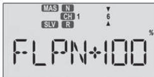
7. Réglez maintenant la quantité de réponse du flaperon droit (voie 1) en appuyant sur la touche "à droite". A présent la petite flèche se déplace sous le chiffre 1 et vous pouvez ajuster le débattement du flaperon droit en utilisant les touches **Data +** et **Data -**.
